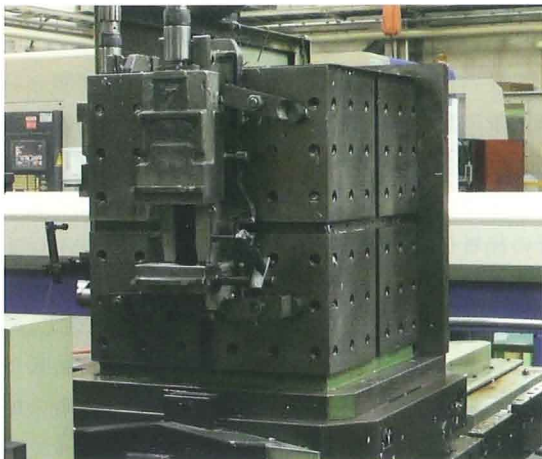
▲工夫された治具により横型MCで高効率生産を行なう
